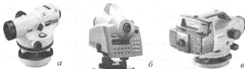
Рис. 3.1. Нивелиры: оптический Nikon AC-2S (а), электронные Trimble DiNi 12 (б), Sokkia SDL30 (в)
